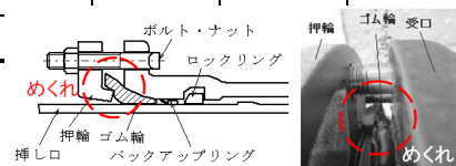
図 接合不良の例
